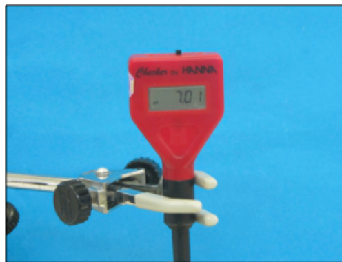
Fig. 49. Muntatge per calibrar el pH-metre amb la solució tampó 7.01.
