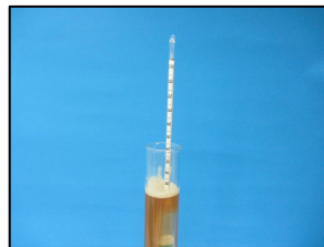
Figures 20. Determinació de la densitat amb el densímetre o areòmetre.
