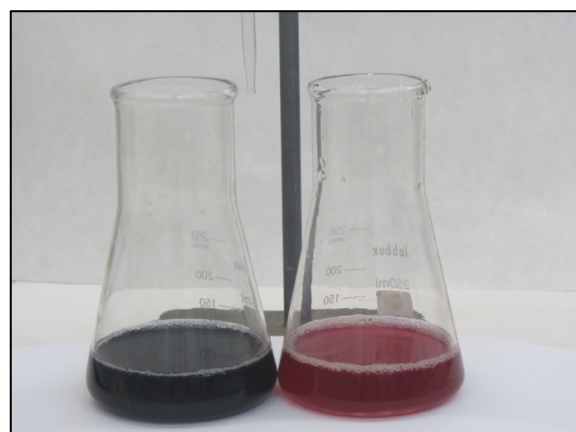
Fig. 58. Viratge de l'indicador blau de bromotímol en la valoració del vi, a la dreta tenim el vi amb dos gotes de bromotímol abans de la valoració i a l'esquerra tenim el vi ja valorat, el blau de bromotímol ha adquirit el color blau fos.
