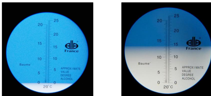
Fig. 25. Mesura en el refractòmetre dels graus Baumé i grau alcohòlic probable en % volum del most.
