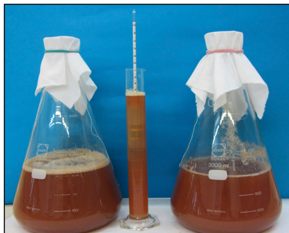
Fig. 21. Quatre litres de most obtingut i estris per determinar la seva densitat.
