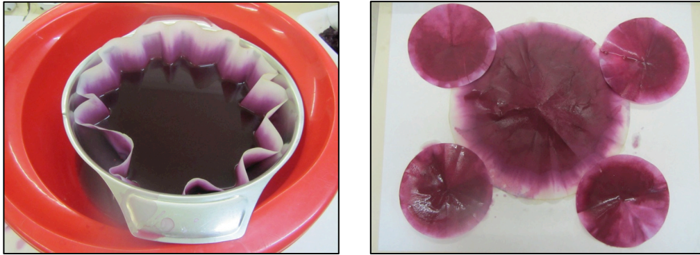
Fig. 36. Muntatge per fer la filtració més ràpidament.
