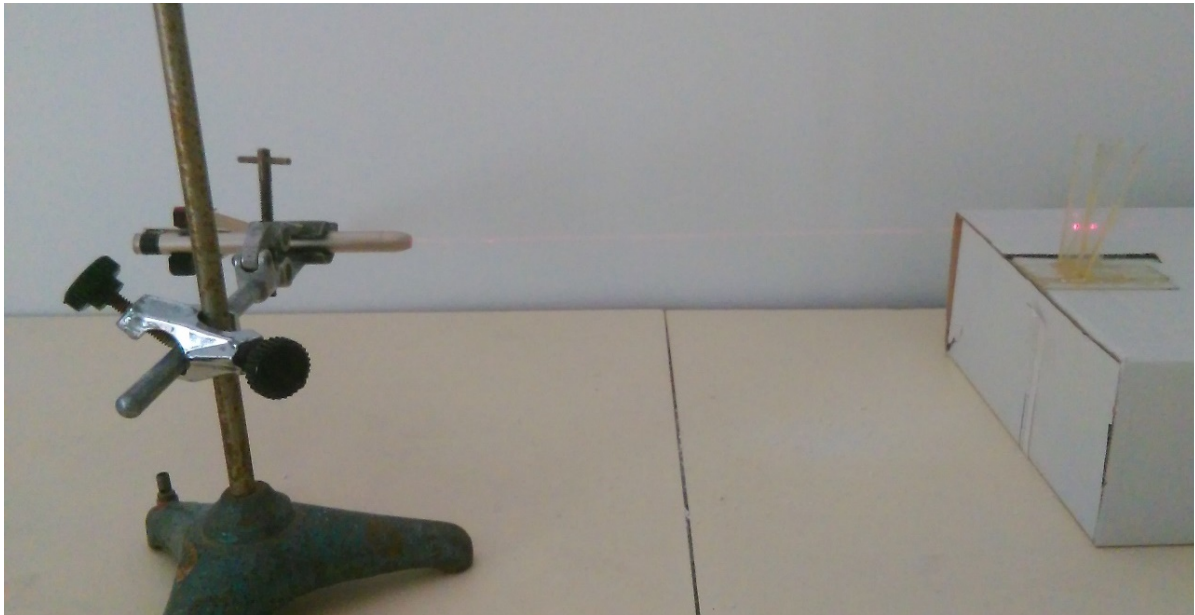
Figura 39. Punter làser subjectat per una pinça en un suport de laboratori incidint en el prisma de refracció.
