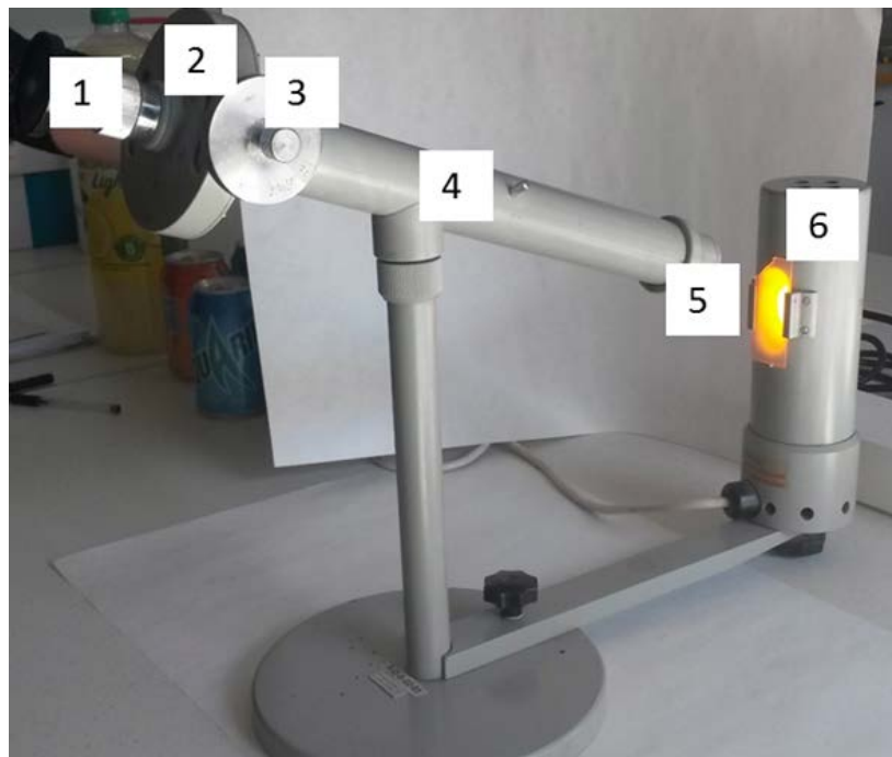
Figura 10. Polarímetre emprat en els experiments 1 i 2
