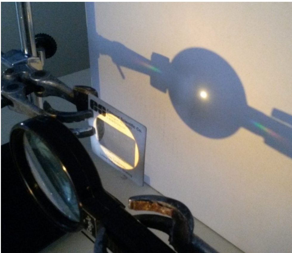
Figura 30. Llum projectada sobre la pantalla blanca un cop s'han disposat la lupa i la xarxa de difracció en el seu camí.
