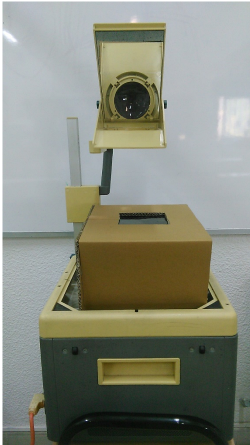
Figura 23. Vista general. El projector és alhora la base del giny i la font de llum.
