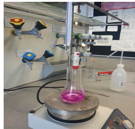
Fig. 28: Vista de la titració àcid-base una vegada la dissolució d'àcid cítric ha adquirit el to rosaci de la fenolftaleïna en medi bàsic. Realització pròpia.
