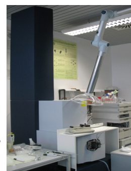
Fig. 30: Vista de l'espectr3metre de masses ESI-TOF que va ser utilitzat per a l'an3lisi de l'3cid c3tric. Realitzaci3 pr3pia.
