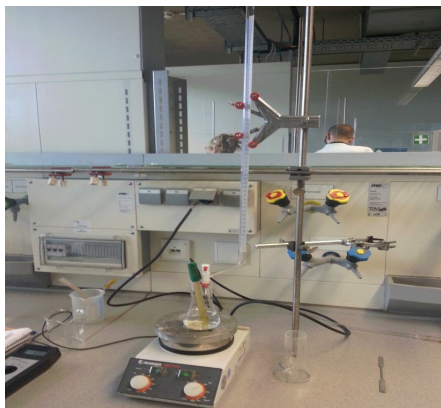
Fig. 29: Vista de la titració àcid-base amb el pH-metre. Realització pròpia.
