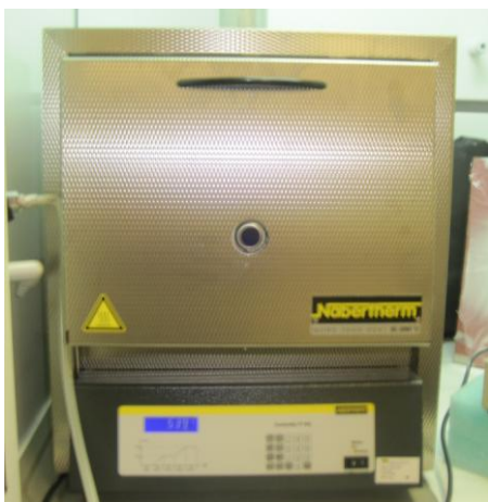
Imatge del forn que s'ha utilitzat per a posar les mostres a uns cicles d'escalfament de 600°C durant 24h per tal que quedés tot el polímer evaporat.
