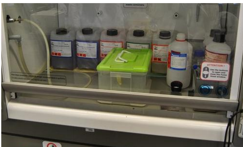
Campana de seguretat amb la capsa que conté les plaques de Petri. En aquest moment s'estava evaporant el cloroform solvent de les mescles i originant-se els films de material.
