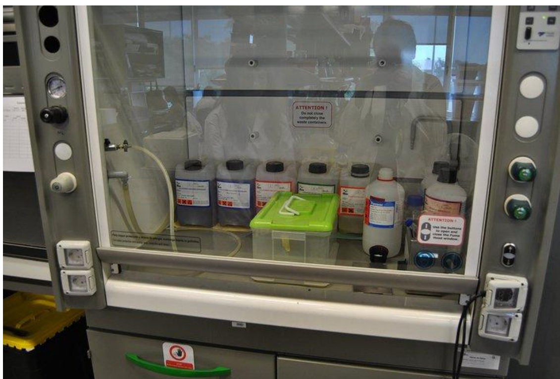
Campana de seguretat amb la capsa que conté les plates de petri per fer els films.
