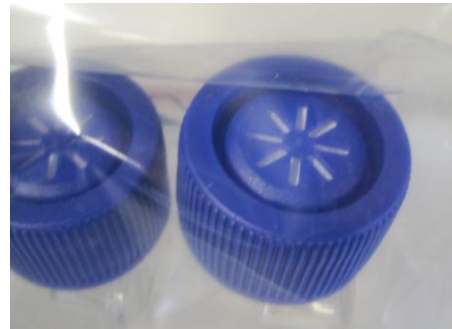
Fotografia del tap d'un flascó, on es pot veure el forat on hi ha el filtre per on surten i entren els gasos.
