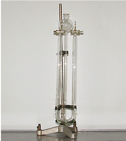
Figura 15: Voltàmetre de Hoffman
