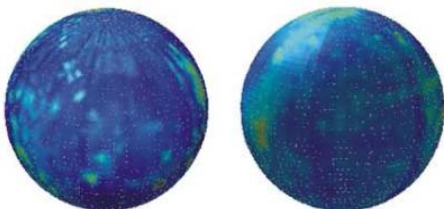
Imatge II: Mapes topogràfics del grossor de les capes de diòxid de silici (SiO 2 ). L'esfera de l'esquerra és l'anomenada AVO28-S5 i la de la dreta, AVO28-S8. El color blau indica un gruix de 2,0nm i el groc de 4,5nm.
