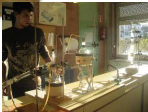
Controlant la destil·lació per arrossegament de vapor.
