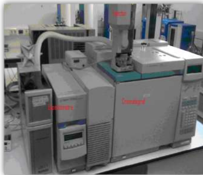
GC-MS utilitzat de l'empresa Solvay.
