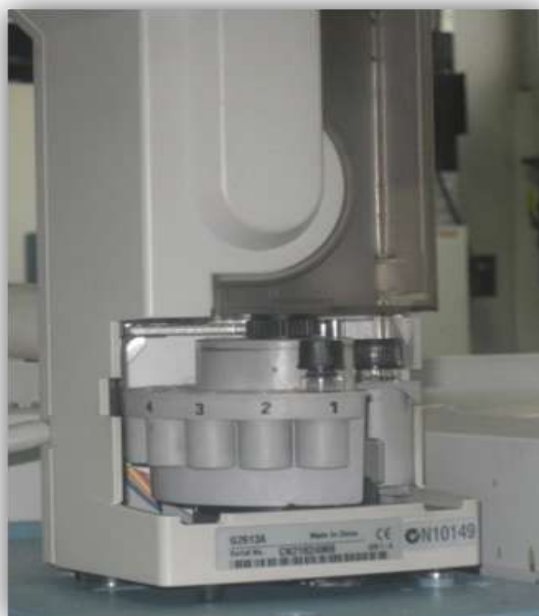
Injecció de la mostra al cromatògraf mitjançant l'injector.
