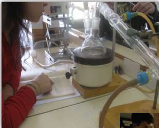
Imatges al laboratori de química del centre, realitzant el muntatge de la destil·lació per arrossegament de vapor.
