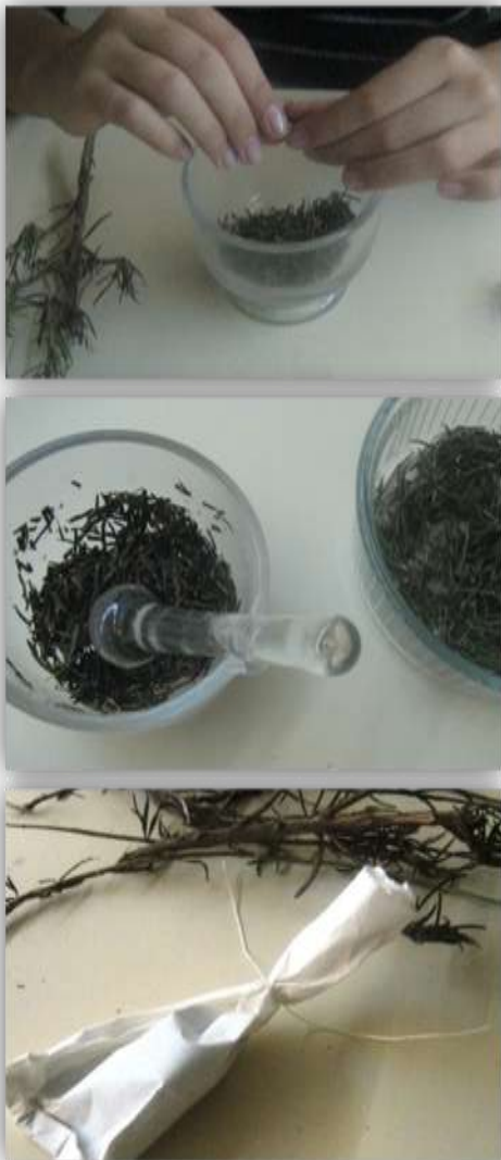
Preparació del romaní per a extraure-li l'essència mitjançant el mètode soxhlet.
