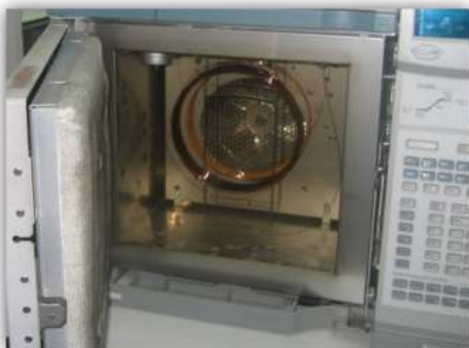
Imatge del cromatògraf per dins, en el qual podem observar la columna.
