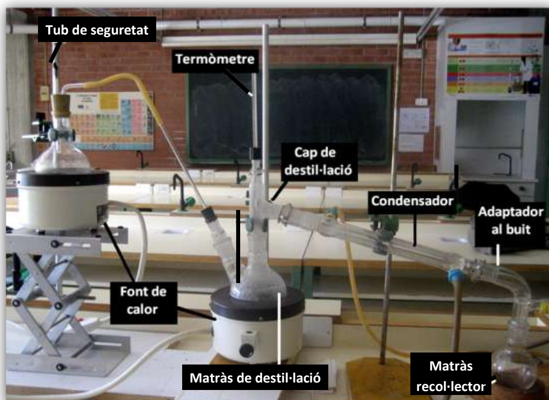
Muntatge de la destil·lació per arrossegament de vapor fet per nosaltres al laboratori de química de l'institut.
